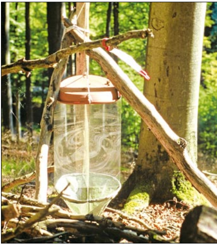
◀ Abb. 4: Bodennahe Flugfensterfalle in der Mitte eines Probekreises als ein Instrument zum Fang von Insekten
